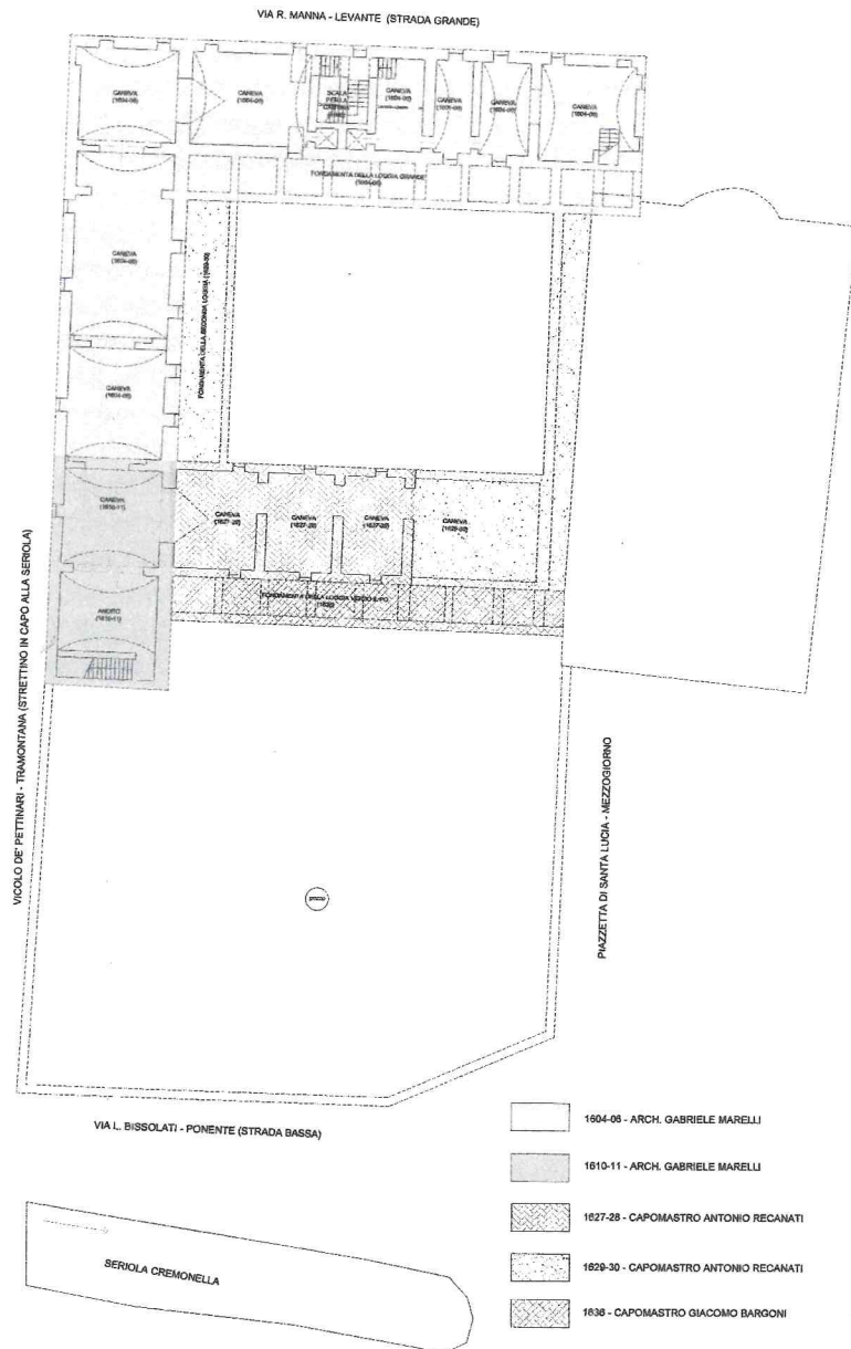
Fig. 3 - Ipotesi di ricostruzione del piano cantinato nel 1650, con individuazione delle fasi costruttive.
